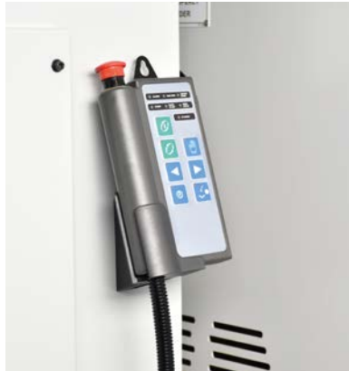
Handbedienelement zum leichten Einrichten
